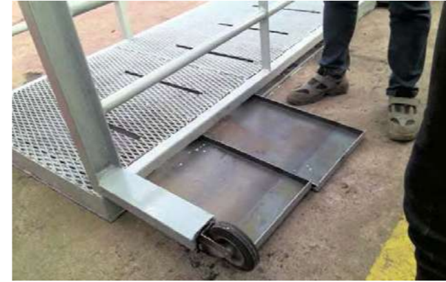
Boya kalıntısı toplamak için prototip çalışma sepeti
