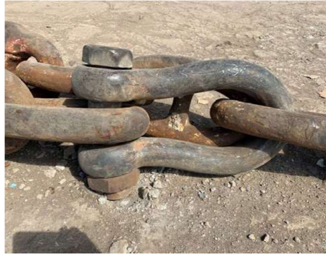
Irgat donanımında deforme olmuş pim ve bağlantı plakalarına örnek
