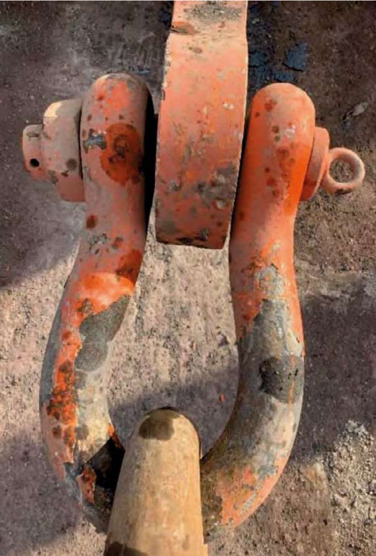
Irgat donanımında deforme olmuş ekipman
